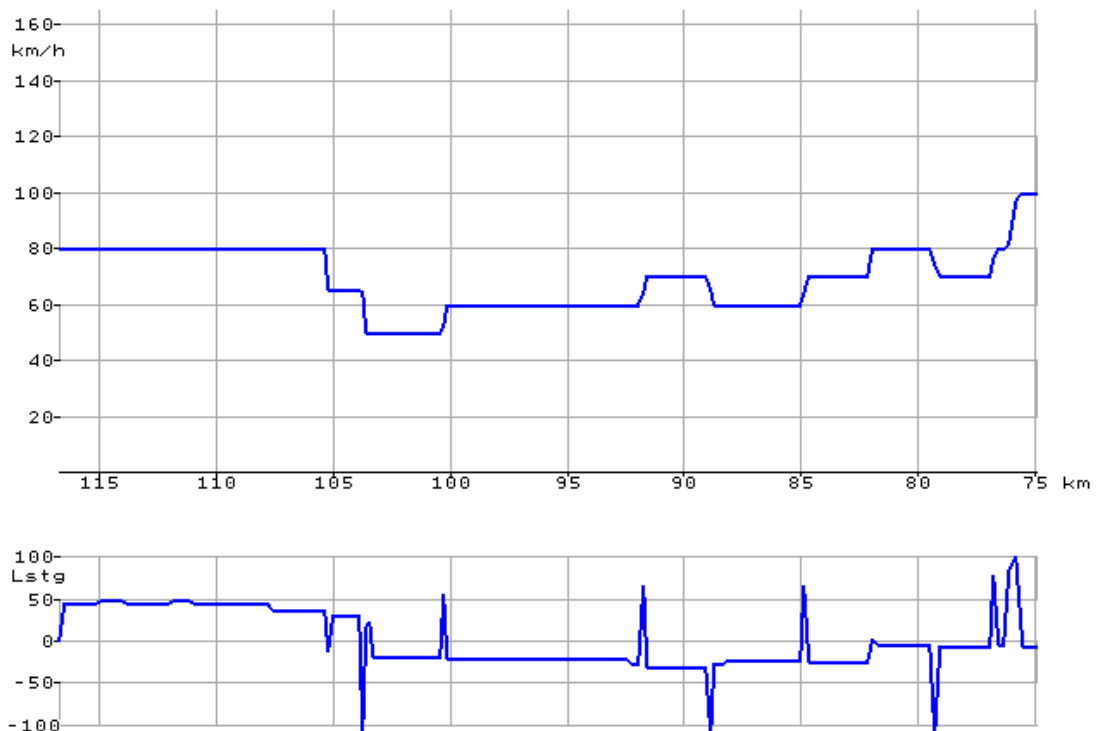
Abb. 7: Geschwindigkeits/Leistungs-Weg-Diagramm Güterzug mit 937 t über die Bergstrecke von Mürzzuschlag (km 117) nach Gloggnitz (km 75)
